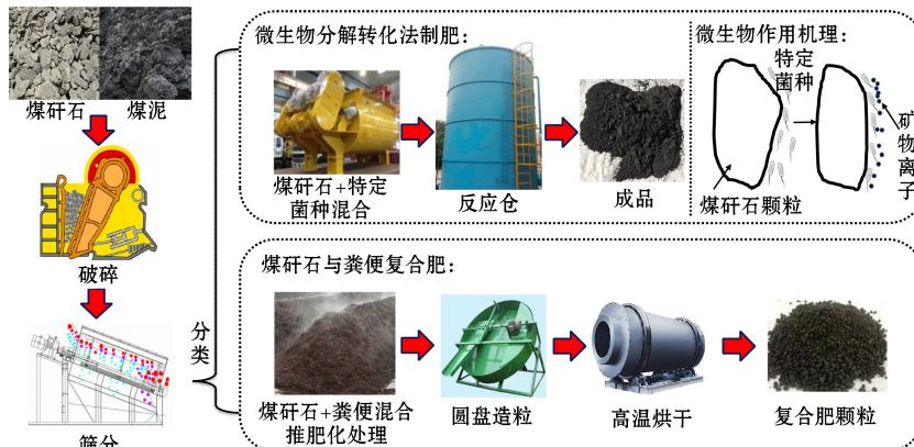
图5 煤矸石制备农业肥料工艺流程
