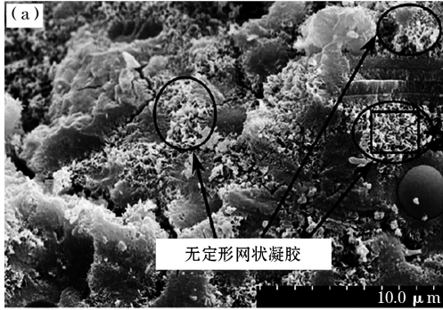
图 5 单掺水泥的 CPB 试件微观图像
