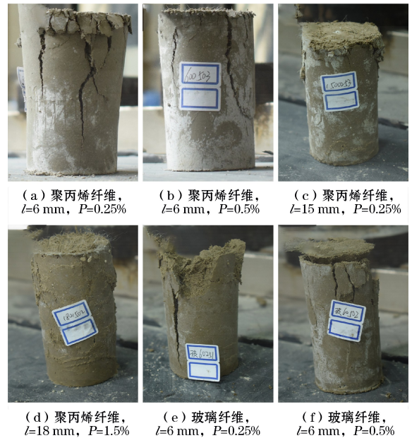
图9 掺纤维尾砂充填体试样单轴压缩破坏形态
